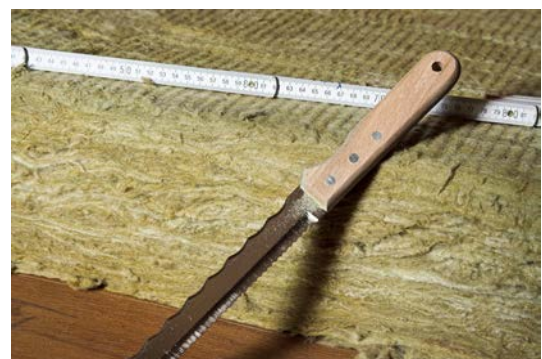
Dämmstoffmesser für den Zuschchnitt von Mineralwolle
