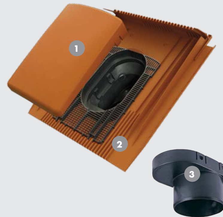
1 Flache Lüfterkappe passend unter Aufdachsolaranlagen 2 Universelle Grundplatte in Standardausführung für flach bis mittel profilierte Dachziegel und Dachsteine, Decklänge 310 - 350 mm 3 Adapter DN 110 und DN 125 für verschiedene Nennweiten
