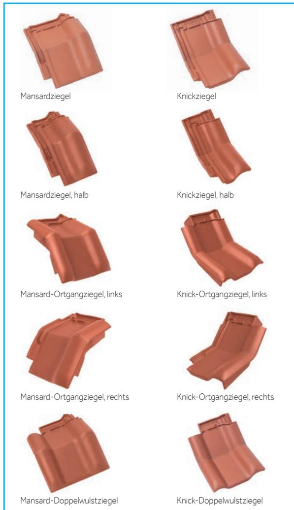
Für einen sicheren Übergang der Dachdeckung bei unterschiedlich geneigten Dachflächen werden Mansard- bzw. Knickziegel eingesetzt. Da der Innenwinkel dieser Pfannen individuell für jedes Bauvorhaben angefertigt wird, ist es besonders wichtig, bereits bei der Planung die genauen Daten festzulegen, damit der Verarbeiter die jeweiligen Pfannen rechtzeitig bestellen kann. Die Mansard- und Knickziegel werden mit einer Schenkellänge von 200/200 mm hergestellt.
